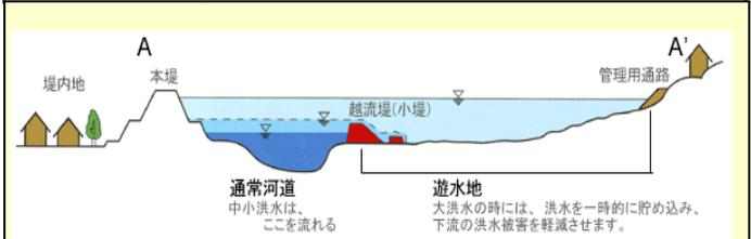
越流堤標準断面図
